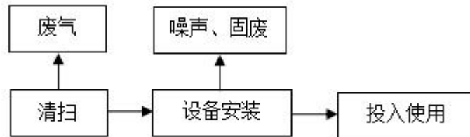
图2 施工期工艺流程及产污环节图
